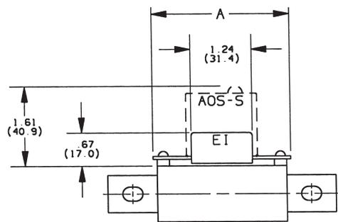
Note : Les fusibles avec l'option EI sont conçus pour le montage des microcontacts AOS-S ou AOS-Q sur commande séparée.
