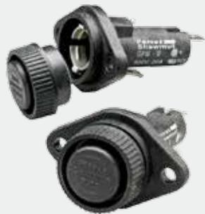
Les porte-fusibles de Mersen pour montage sur panneau GPM sont de dimensions adaptées aux fusibles de Classe CC et Midget (1 1/2" x 13/32"). Tous les supports 30A sont équipés d'isolants en PET pour une plus grande fiabilité et une facilité d'installation. De conception brevetée, les boîtiers acceptent les capuchons à vis ou à baïonnette. La configuration de la bride permet un montage avant ou arrière.
