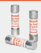
Les fusibles Midget OTM fournissent une protection économique à une tension de 250 volts CA aux circuits d'éclairage, de chauffage et des circuits de contrôle, etc ...où une temporisation n'est pas requise. (Ne pas utiliser sur les circuits de distribution).
