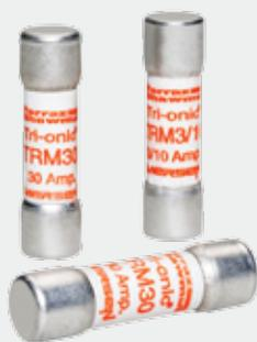
Les fusibles Midget Tri-Onic® temporisés TRM ont une tension de 250 volts CA et sont disponibles de 1/10 à 30A. Ils ont une temporisation de 12 secondes à 200% du calibre nominal pour une protection additionnelle de petits moteurs, de petits transformateurs et autres charges à haut courant d'appel à 250Volts. (Ne pas utiliser sur les circuits de distribution).
