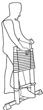
**3** Achten Sie darauf, dass beide Top-Holme vollständig ausgezogen sind und testen Sie, ob die Verriegelungsstifte automatisch einrasten. Kontrollieren Sie, dass keine rote Markierung direkt neben den Knöpfen zu sehen ist. Wenn eine rote Markierung neben den Knöpfen zu sehen ist, diese entriegeln und dann nach dem Einschieben der Top-Holme die Knöpfe loslassen. Den Vorgang des Ausziehens wiederholen, bis der Top-Holm korrekt verriegelt und keine rote Markierung mehr zu sehen ist.
