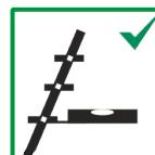
4.17 Anlegeleitern mit Stufen müssen so verwendet werden, dass die Stufen sich in horizontaler Lage befinden.
