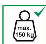
4.11 Die Leiter darf nicht mit mehr als 150 kg belastet werden. Dies umfasst Ihr eigenes Gewicht, das Gewicht von Materialien und Werkzeug sowie die zusätzliche Kraft, die während des Arbeitens entsteht. Sollten Sie bzgl. des Gewichts unsicher sein, benutzen Sie die Leiter nicht und wenden Sie sich an Ihren Händler oder setzen Sie ein Gerüst ein.
