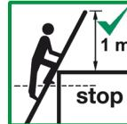
4.16 Wenn Sie die Leiter als Zugang zu einem Dach verwenden, achten Sie darauf, dass die Leiter 1 m über die Dachkante hinausragt, sodass Sie beim Aufsteigen auf das Dach genügend Halt haben. Steigen Sie dabei nicht höher als bis zur Dachkante, um zu vermeiden, dass die Leiter kippt. Im Zweifel binden Sie die Leiter fest oder schlagen Stifte in den Boden, um die Leiterfüße zu sichern.
