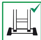
4.4 Verwenden Sie die Leiter niemals ohne Standfußtraverse. Diese muss vor der Verwendung montiert werden.
