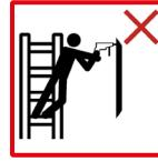
4.20 Évitez toute tâche exerçant une charge latérale sur l'échelle, par exemple le perçage, sur le côté, de matériaux durs.
