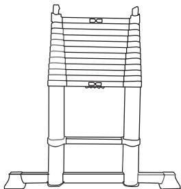
2 Mettez un pied sur le stabilisateur pour pouvoir déployer plus facilement l'échelle. Veillez à ce que l'avant de l'échelle soit face à vous, de telle manière que les boutons de verrouillage soient visibles.
