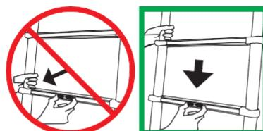
**15** Entriegeln Sie die Arme des Wandabstandshalters, indem Sie die Vierriegelung auf dem Arm des Wandabstandshalters entriegeln und ihn gleichzeitig in senkrechte Position bringen. Erst wenn beide Arme senkrecht stehen, können Sie sie wieder in den Leiterholm einschieben. Falten Sie anschließend die Werkzeugtasche flach zusammen und verschließen Sie den Klettverschluss.
