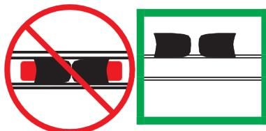
**10** Sous les échelons, les témoins de verrouillage doivent être entièrement visibles.
