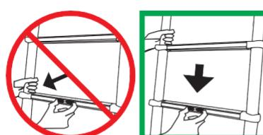
**15** Débloquez les bras de l'écarteur en déverrouillant le bouton de verrouillage sur le bras de l'écarteur tout en plaçant ce dernier en position verticale. Une fois que les deux bras sont à la verticale, vous pouvez les glisser dans le montant de l'échelle.
