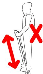
**7** Wenn Sie eine kürzere Leiterlänge nutzen möchten, dann lassen Sie den nicht genutzten Leitere teil am oberen Ende der Leiter eingeschoben. Dadurch haben Sie immer den korrekten sicheren Sprossenabstand.
