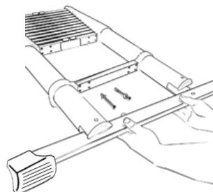
**7** Serrez fermement les deux vis avec leurs rondelles. Le stabilisateur, une fois fixé, ne doit présenter aucun mouvement. Il est nécessaire de vérifier régulièrement le serrage.
