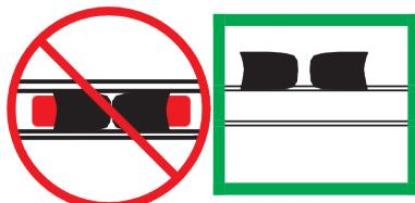
**10** Unter den Sprossen müssen die roten Verriegelungsanzeigen vollständig zu sehen sein.
