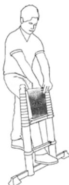
**3** Öffnen Sie die Werkzeugtasche, indem Sie den Klettverschluss öffnen und lesen Sie vor dem Gebrauch die Anleitung. Die Werkzeugtasche ist für die Aufbewahrung von leichtem Werkzeug und Material mit maximal 2,5 kg Gewicht vorgesehen.
