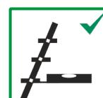
4.17 Anlegeleitern mit Stufen müssen so verwendet werden, dass die Stufen sich in horizontaler Lage befinden.
