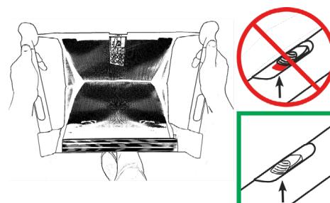
**6** Ziehen Sie die Leiter komplett aus und kontrollieren Sie Sprosse f. ir Sprosse, ob diese gut eingerastet sind. Nur wenn die Verriegelungsanzeige vollständig sichtbar nach unten hängt, ist die Sprosse korrekt eingerastet.
