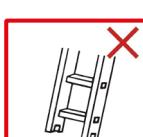
**4.35** Verwenden Sie die Leiter niemals ohne Standfußtraverse. Diese muss vor der Verwendung montiert werden.
