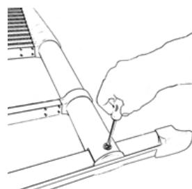
**8** Les écrous sont prémontés dans la protection en plastique du montant de l'échelle.
