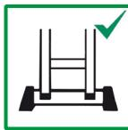
4.4 Si l'échelle est livrée avec des barres stabilisatrices, elles doivent être fixées avant la première utilisation.
