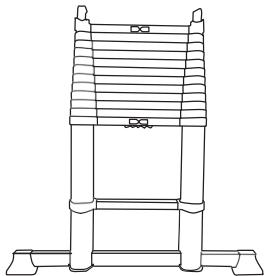
**2** Stellen Sie einen Fuß auf die Standfußtraverse, um die Leiter einfacher ausziehen zu können. Achten Sie darauf, dass die Vorderseite der Leiter zu Ihnen zeigt, sodass die Verriegelungsknöpfe sichtbar sind.
