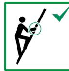
4.15 Tenir fermement l'échelle en montant ou en descendant. Si possible, se tenir d'une main à l'échelle pendant l'exécution de la tâche, sinon prendre d'autres mesures de sécurité.
