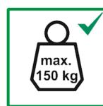
4.11 Die Leiter darf nicht mit mehr als 150 kg belastet werden. Dies umfasst Ihr eigenes Gewicht, das Gewicht von Materialien und Werkzeug sowie die zusätzliche Kraft, die während des Arbeitens entsteht. Sollten Sie bzgl. des Gewichts unsicher sein, benutzen Sie die Leiter nicht und wenden Sie sich an Ihren Händler oder setzen Sie ein Gerüst ein.
