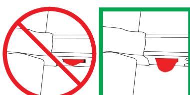
**11** Veillez à ce que les deux morceaux de caoutchouc de protection murale soient correctement posés contre le mur.
