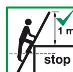
4.16 Wenn Sie die Leiter als Zugang zu einem Dach verwenden, achten Sie darauf, dass die Leiter 1 m über die Dachkante hinausragt, sodass Sie beim Aufsteigen auf das Dach genügend Halt haben. Steigen Sie dabei nicht höher als bis zur Dachkante, um zu vermeiden, dass die Leiter kippt. Im Zweifel binden Sie die Leiter fest oder schlagen Stifte in den Boden, um die Leiterfüße zu sichern.
