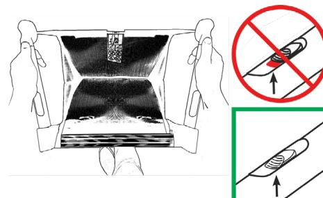
6 Déployez entièrement l'échelle et vérifiez que chaque échelon est bien verrouillé. L'échelon est correctement enclenché si le témoin de verrouillage est entièrement visible et pend vers le bas.
