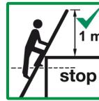
4.16 Si vous utilisez l'échelle pour accéder à un toit, veuillez à ce que l'échelle dépasse le bord du toit d'1 m afin de que vous ayez un maintien suffisant en descendant. Néanmoins, ne montez pas plus haut que le bord du toit pour éviter que l'échelle ne bascule. En cas de doute, attachez l'échelle ou enfoncez les pieds de l'échelle pour les bloquer.
