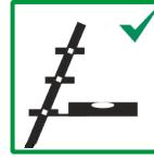
4.17 Les échelles d'appui à marches doivent être utilisées avec les marches en position horizontale.
