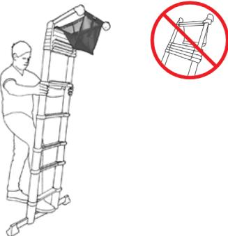
**8** Appuyez l'échelle contre le mur selon une inclinaison correcte. Pour contrôler l'inclinaison de l'échelle, placez les pieds devant les pieds de l'échelle, et touchez le montant de l'échelle avec les deux mains, les deux bras à l'horizontale.
