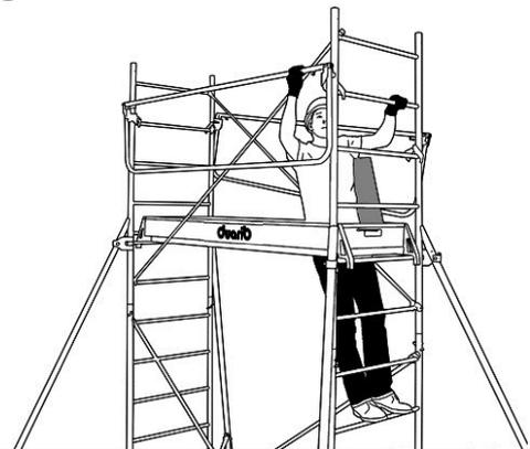
56 Les garde-corps se trouvent à 1m du plancher. Verrouiller les garde-corps.
