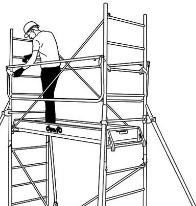
52 Monter un côté du plancher par la trappe.
