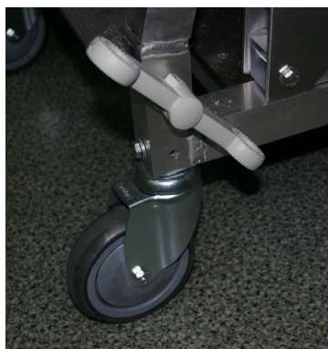
Blocage des roulettes côté accès
