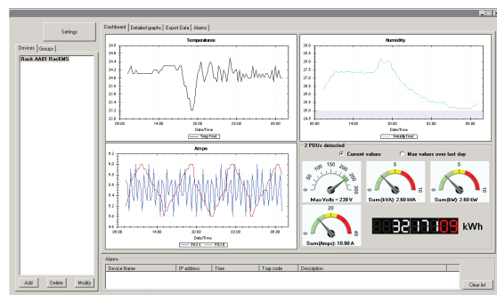
Det overskuelige instrumentpanel viser alle strøm- og miljødata som grafer over tendensen for valgte enheder i de seneste 24 timer.
