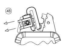
POSITION B: INTENDED FOR RINGS/FORKS SLIDE LOCATOR AS SHOWN
