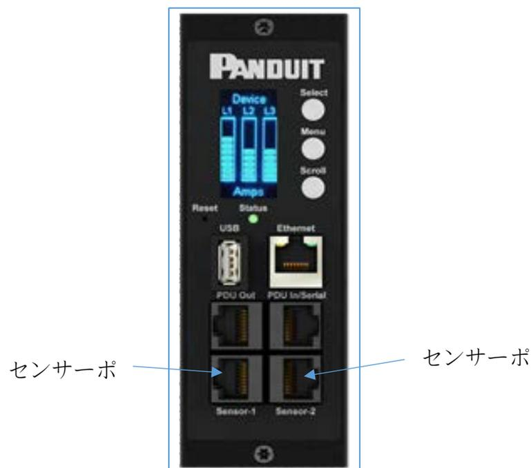
図91: コントローラのセンサーポート
