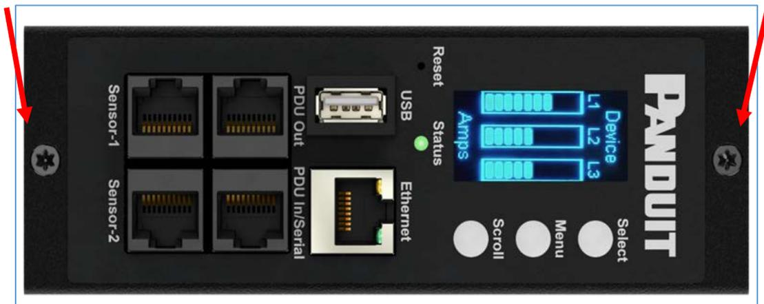
図93 ネットワークコントローラのネジ
