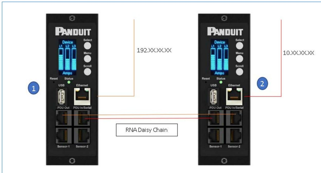
図 69: 接続図 RNA デイジー チェーン
