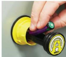
4. Schieben Sie das Batteriefach wieder in das Gehäuse. Sobald das Batteriefach eingesetzt und die Verbindung zwischen der Batterie und der Elektronik des AVT hergestellt ist, wird ein Selbsttest durchgeführt.
