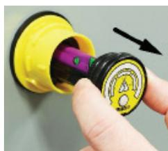
3. Entfernen Sie die verbrauchte Batterie. Setzen Sie eine neue Batterie ein. Stellen Sie vor dem Fortfahren sicher, dass die Batterie richtig sitzt.
