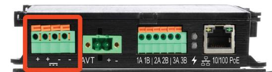
**IMPORTANTE** La fuente de alimentación debe estar protegida contra sobretensiones; de lo contrario, necesitará contar con una protección externa contra sobretensiones en la entrada de la alimentación.
