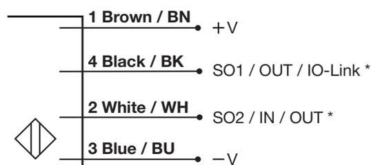
\* Les sorties peuvent être configurées via IO-Link
