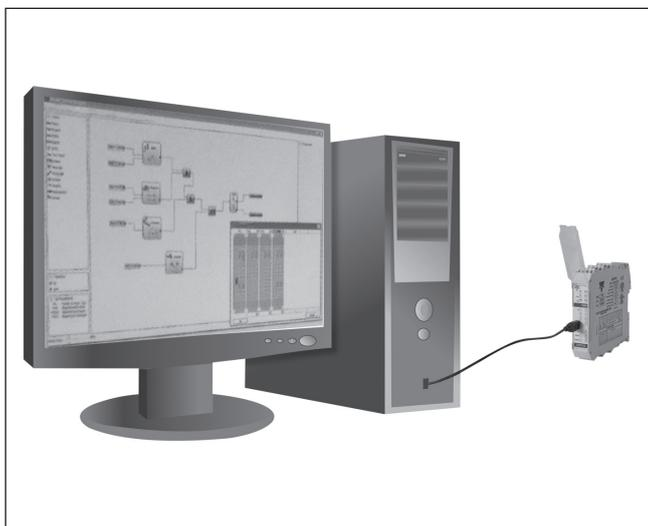
La convivialité du logiciel de configuration CSS permet de programmer le CMM en quelques opérations simples. Un clic sur les icônes fonctionnelles permet de « glisser déplacer » les fonctions de sécurité à configurer.
