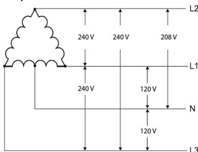
Fig. 4 Système biphasé avec neutre (3 fils)
