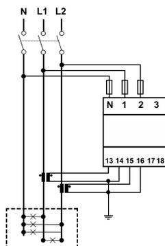
**Fig. 8** Système biphasé avec neutre (3 fils)
