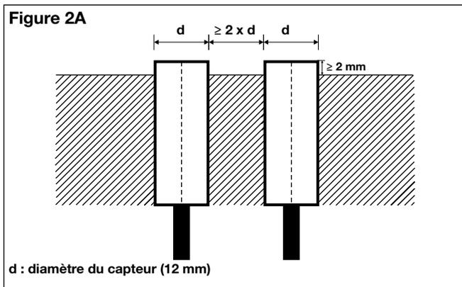
Détecteur avec montage non-noyable, les distances mini de montage doivent être respectées suivant la fig. 1B.
