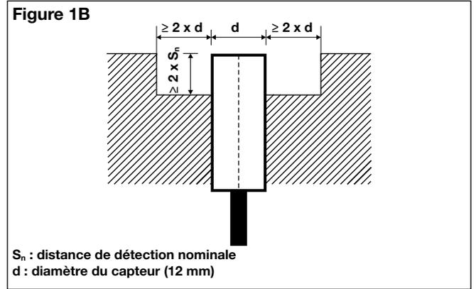
Détecteur avec montage non-noyable, les distances mini de montage doivent être respectées suivant la fig. 2B.
