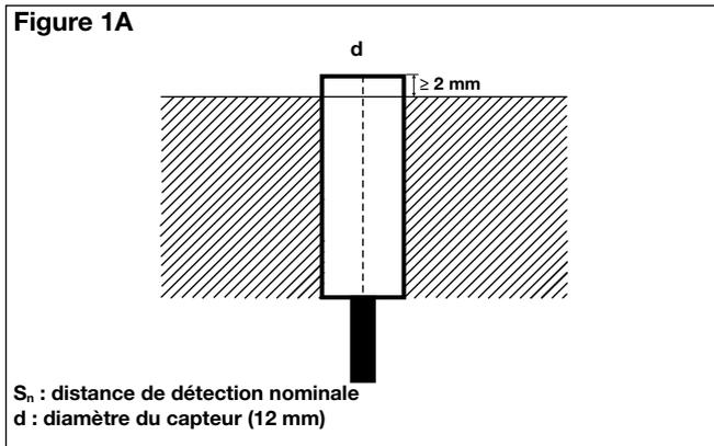
Détecteur avec montage quasi-noyable, les distances mini de montage doivent être respectées suivant la fig. 2A.
