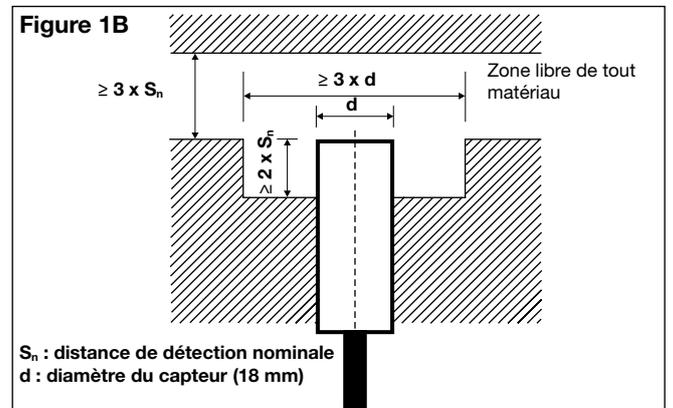
Détecteur affleurant en montage noyable, les distances mini de montage doivent être respectées suivant la fig. 2A.
