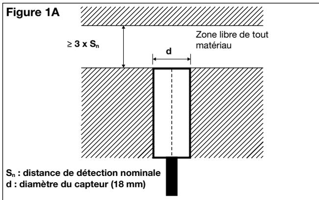
Détecteur en montage non-noyable, les distances mini de montage doivent être respectées suivant la fig. 2B.
