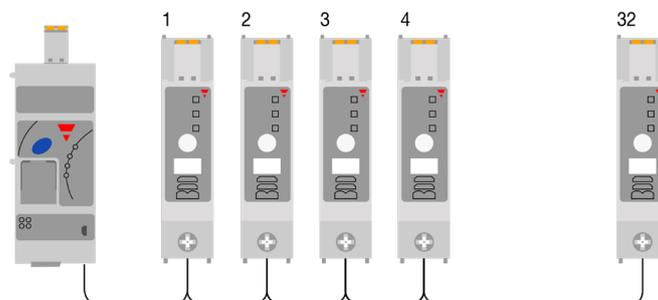
En cas de remplacement d'un RG..N ou de toute modification apportée au bus NRG, le RG..N doit faire l'objet d'un nouvel adressage. Suivez la procédure ci-dessous pour réadresser manuellement les RG..N du bus NRG. L'auto-adressage peut également être effectué via communication (pour plus d'informations, voir le manuel d'utilisation NRG Modbus TCP)
