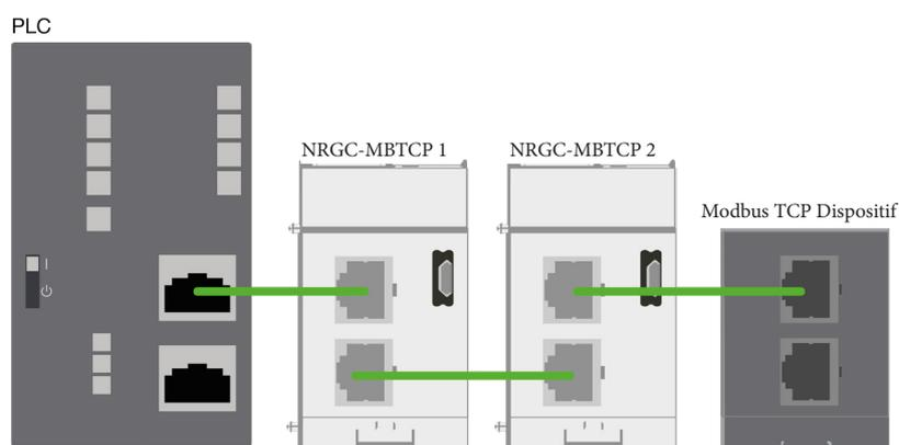
Fig. 3 Exemple d'une configuration en ligne du NRGC-MBTCP avec d'autres appareils et contrôleur Modbus TCP
