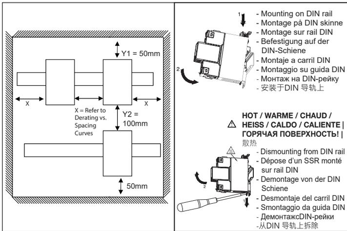
**Mounting Instructions for RGS | Installationsvejledning til RGS | Instrucciones de montaje para RGS | Installationsanleitungen für RGS | Instructions d'installation pour RGS | Istruzioni per l'installazione per RGS | Руководство по монтажу для RGS | 安装说明对于 RGS**
