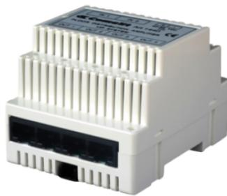
Dérivateur d'étage (switch) pour système vidéophonique IP et l'acheminement des paquets de données du système ViP Comelit. Doté de 6 ports de communication ethernet avec PoE Comelit (10/100Mbit/s). L'art. 1440A négocie la vitesse de connexion en fonction des dispositifs connectés et le PoE Comelit permet d'alimenter plusieurs articles 1440A en cascade, ce qui augmente les distances de connexion du système par rapport à la norme PoE. Dimensions : 71x89x62 mm (4 modules DIN).
