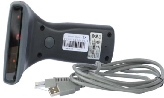
Lecteur portatif de code barre permettant de relever le code barre disponible sur tous les produits de la gamme VIP à programmer, suivants: combinés/moniteurs, platines de rue, actionneurs, etc. Livré avec interface et câble USB permettant la connexion à un PC.
