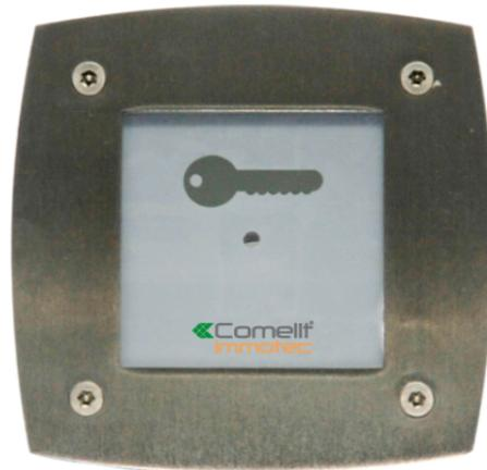
Antenne de lecture antivandale intégrée dans un boîtier à encastrer façade inox 2 mm et polycarbonate 6mm - Fixation par 4 vis antivandales - Distance de lecture : 4cm - Technologie MIFARE compatible centrales ACM/R, UG - Sortie WIEGAND 32 bits pour utilisation sur autres systèmes - Dimensions façade: 110x 110 mm - Dimensions boîtier: 90x 90x 45 mm
