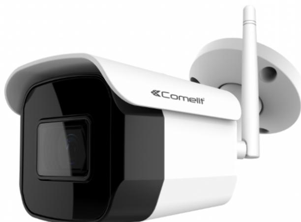
Caméra IP Wi-Fi all-in-one couleur Jour/Nuit, optique fixe de 3.6 mm, résolution FULL-HD (1080p)@30 ips, habillage étanche IP66, 20 leds à infrarouge avec distance de fonctionnement de 30m (Smart IR), compatible ONVIF 2.4. Alimentation fournie.
