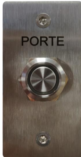
Poussoir lumineux NO/NF. Fermeture par 2 vis, antivandales. Façade en acier inox, gravée "PORTE". Dimensions façade (L x H): 35x60mm.
