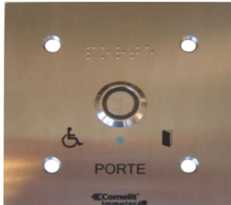
Bouton lumineux et sonore NO/NF, montage encastré. Fermeture par 4 vis, antivandales.
