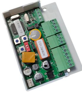
Centrale de contrôle d'accès, gestion RESIPRO/des claviers SKRV en mode IP - utilise les badges de proximité réf: CLE (10 couleurs) - A compléter avec clavier SKRV - Boîtier PVC dimensions : 65 x 85 x 20 mm.
