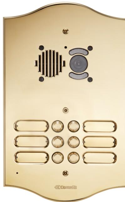
Platine audio avec plaque frontale réalisée à partir de plaques en laiton d'horlogerie de 3 mm d'épaisseur avec finition PVD. Avec boîtier d'encastrement et vis anti-vandale. Toutes les platines disposent d'un porte lampes pour lampes tubulaires 6,3 x 39 mm. (livré sans lampes) Compléter la platine avec le groupe audio-vidéo correspondant au système de câblage utilisé. 24 boutons, 4 rangées. Dimensions plaque 340x362x3 mm. Dimensions boîtier 320x296x55 mm. 3 porte lampes
