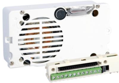
Groupe audio pour système ViP. Avec bornier et système numérique de gestion de la fonction phonique avec rattrapage automatique d'écho, haut-parleur à volume réglable . À insérer dans les modules art. 33400, 33401, 33402. Dimensions : 102x55x38 mm.
