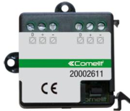
Interface de connexion entre le BUS SimpleHome et un ordinateur. L'interface dispose d'un connecteur USB pour la connexion à l'ordinateur (câble USB non fourni). Permet de configurer l'installation à travers le logiciel SimpleProg. Le même bus peut rassembler simultanément plusieurs interfaces. Dimensions 42x42x18mm (1 module DIN).
