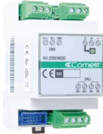
Module interface entre le BUS SimpleHome et le BUS DALI ou le BUS DMX. L'interface permet d'envoyer des commandes pour l'activation ou la désactivation de groupes de lampes reliées au systèmes. Il est également possible de contrôler ou d'ajuster les lampes à partir des boutons, des superviseurs et de l'application Comelit. Pilote jusqu'à 64 lampes sur les deux BUS (DALI/DMX) ou jusqu'à 16 lampes RGB (seulement DMX). Dimensions: 3 modules DIN.
