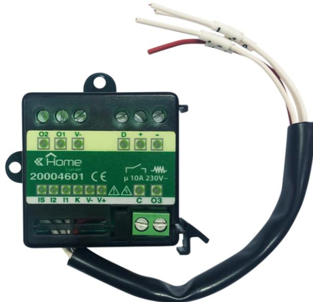
Interface sur bus SimpleHome 3 entrées et 3 sorties configurables dont 1 relais 16A NO/NF et 2 Open Collector à utiliser pour la commande d'un relais extérieur type Art. 20004603. Montage par encastrément ou sur rail DIN. Dimensions 42x42x18mm (1 module DIN). Consommation maxi: 115mA.
