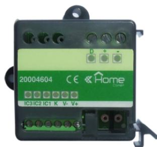
Interface sur BUS SimpleHome 3 entrées de type impulsionnel à relier aux compteurs avec sortie à impulsions (par ex. eau, gaz, calories). Reliée à un superviseur (Mini Touch ou Planux Manager), permet de visualiser les consommations sous forme de graphiques ou de tableaux. Montage par encastrement ou sur rail DIN. Dimensions 42x42x18mm (1 module DIN).
