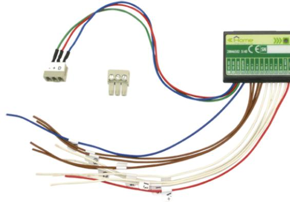
Module SimpleHome 5 entrées numériques pour relier jusqu'à 5 boutons (4 + 1 scénario) et 4 sorties Open Collector pour relier des voyants 24 Volt(max. 50 mA) ou des interfaces à relais (par ex. 20046912 et 20004692), dimensions 41x29x9 mm , à connecter au BUS SimpleHome. Consommation 20 ma.
