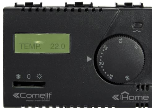
Module thermostat équipé de sonde de température intégrée et d'écran lcd pour l'affichage et la régulation de la température ambiante , avec commutateur manuel « été/hiver/arrêt » et entrée de changement de mode jour/nuit , peut commander une électrovanne/chaudière par l'intermédiaire du relais intégré ou une sortie sur modules SimpleHome. Peut commander un ventilateur-convecteur 3 vitesses. Dimensions : 3 modules à encastrer , fourni avec adaptateurs standards.
