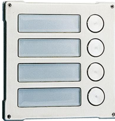
Module double plaque en acier inox 316 de 2,5 mm, avec 4 boutons en acier inox et étiquette porte-noms rétroéclairée. Délivre des contacts secs uniquement. Dimensions : 106x106x21 mm
