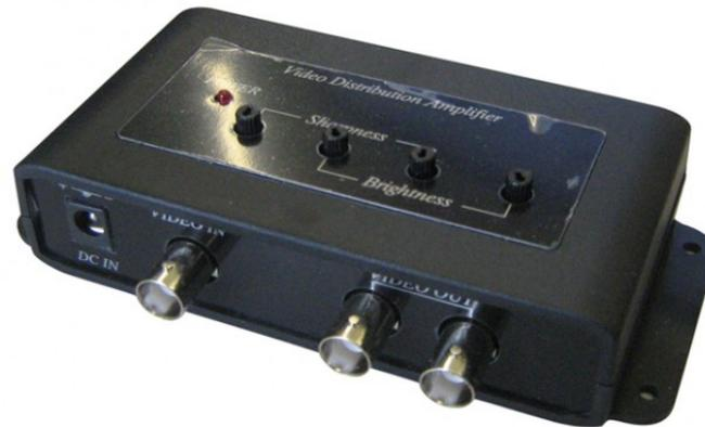
Distributeur vidéo amplifié, 1 entrée vidéo, 2 sorties vidéo, distance pouvant être atteinte avec câble RG59 1000 m, alimentation 12 VDC, habillage plastique, alimentation comprise.
