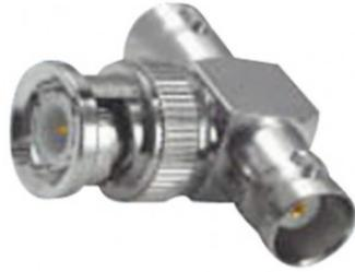
Adaptateur en T de fiche type BNC à double prise type BNC, corps en laiton nickelé et isolation en teflon, approprié pour connecteurs art. 43660, art. 43661, art. 43663 et art. 43665 (boîte de 10 pièces).
