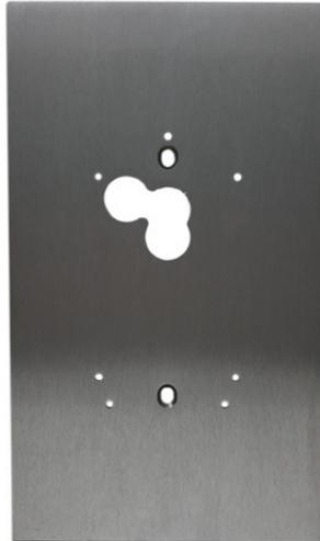
Platine permettant d'installer les postes extérieures Extra, Ciao et Quadra sur des boîtes à encastrer à 1 et 2 modules de Comelit, Bticino et Urmet. Dimensions (LxHxP): 137x236x2.5 mm.
