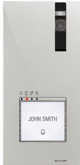
Platine extérieure vidéophonique en saillie série Quadra. Façade en aluminium moulé sous pression, caméra couleurs avec une led d'éclairage nocturne. Boutons mécaniques avec possibilité de configurer de 1 à 4 boutons d'appel par DIP-SWITCH. Led de signalisation d'appel envoyé, ouvre-porte activé, phonie activée et ligne occupée. Réglage du volume du haut-parleur et équilibrage phonie. Alimentation POE. Dimensions (L x H x P) : 95 x 195 x 28mm.
