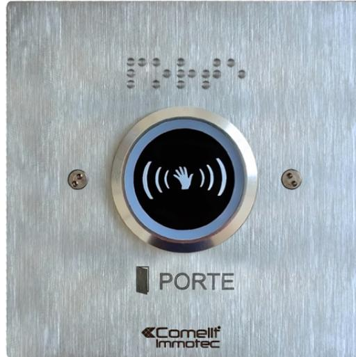
Bouton sans contact C-NO-NF monté sur une façade en acier inox, gravée PORTE. Fermeture par 2 vis sur un pot de 60 mm de diamètre. Distance de détection : 4 à 12 cm. Réglage de la temporisation d'ouverture de 1 à 25 s. Dimensions façade (L x H x P) : 100 x 100 x 2 mm.
