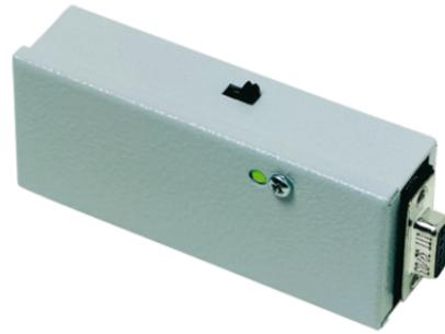
Interface permettant le dialogue infrarouge avec les centrales UG2, UG4 et ACM/R
