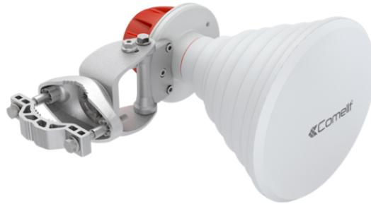
Antenne à faisceau symétrique de 30° avec gain : 18,4 dB. Dotée de connecteurs N-femelle, fréquence 5180 - 6400 MHz, largeur de faisceau -6 dB : H 30° / V 30°, inclinaison mécanique :  $\pm 25^\circ$ , diamètre de montage sur mât : 30- 90 mm.
