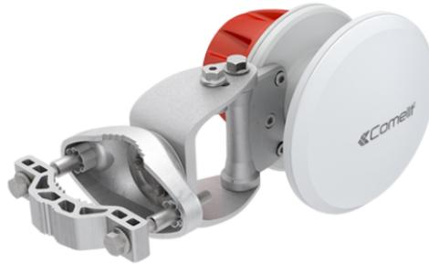
Antenne à faisceau symétrique de 90° avec gain : 9,6 dB. Dotée de connecteurs N-femelle, fréquence 5180 - 6400 MHz, largeur de faisceau -6 dB : H 90° / V 90°, inclinaison mécanique :  $\pm 25^\circ$ , diamètre de montage sur mât : 30- 80 mm.
