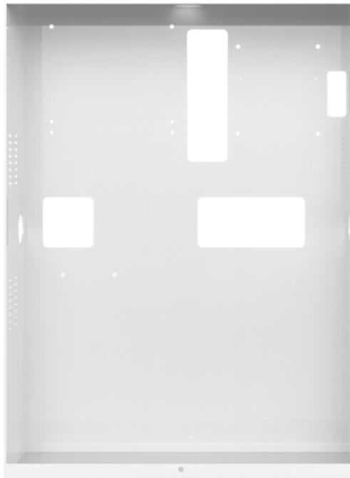
Boîtier mural métallique couleur blanc pour cartes centrale série VEDO art. PCBVEDO10FR, PCBVEDO34FR et PCBVEDO68FR. Peut accueillir les batteries 7 Ah ou 15 Ah, les alimentations art. PSU15 ou PSU50, 2 cartes d'extension sur bus, autoprotection à l'arrachement et à l'ouverture. Dimensions (L x H x P) 315 x 440 x 100 mm. Certifiée EN50131 niveau 2.
