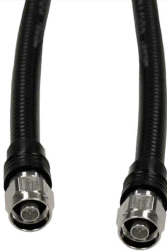
Câble coaxial superflex 1/2" à faible perte avec connecteur N mâle aux deux extrémités, type FSJ4-50B, impédance  $50\Omega \pm 1\%$ , fréquence = 10 GHz.
