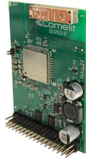
HUB2G est le module GSM/GPRS insérable qui permet d'activer la centrale Secur Hub à l'envoi d'appels téléphoniques et de SMS. Le module se connecte en outre au cloud Comelit et permet l'envoi d'e-mails et de notifications. Le module peut également être utilisé pour gérer la centrale à partir de l'application Comelit, comme vecteur principal ou secondaire en cas de connectivité Wi-Fi ou LAN disponible.
