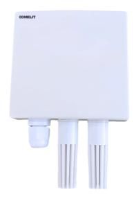
Détecteur permettant d'analyser les particules, PM10 et PM2.5, selon le principe de diffusion de la lumière laser. Le dispositif est en mesure de déterminer la concentration par unité de volume ainsi que le diamètre des particules. Le détecteur SENSPM10 utilise comme canal de communication un port RS485 connecté aux caméras LPRCAM, servant à transmettre la valeur des particules mesurées aux métadonnées fournies par la caméra puis enregistrées dans le logiciel SWCPS.
