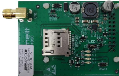
Carte d'extension transmetteur GSM pour centrales série VEDO. Permet de faire des appels téléphoniques, d'envoyer des SMS, MMS et des mails sur le réseau DATA. Associée à la carte messages vocaux art. VEDOVOICE, permet le contrôle à distance de la centrale via SMS et transmetteur vocal. EN50131 Grade 2.
