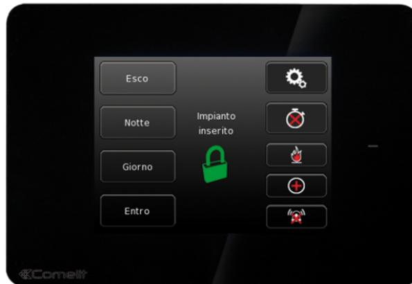
Clavier Safetouch écran tactile LCD 3,5" et lecteur de proximité intégré pour le contrôle et la programmation des centrales d'alarme de la série VEDO, équipé de 3 entrées à programmation libre comme entrées NF, NO, simple, double, triple équilibrage et double ou comme sorties, et d'1 sortie relais. Procède au contrôle vidéo de l'alarme en affichant jusqu'à 4 images des caméras associées. Se monte sur un boîtier standard 3 modules. Dimensions 125x85 mm. Saillie du mur de 10 mm. Consommation 2W.
